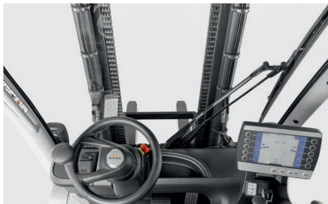
El mástil telescópico ofrece una excelente visibilidad hacia delante
