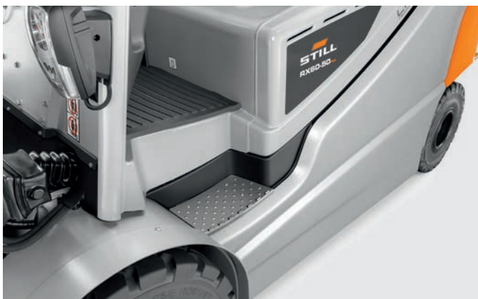
Alto nivel de seguridad gracias a los amplios escalones antideslizantes que facilitan el acceso
