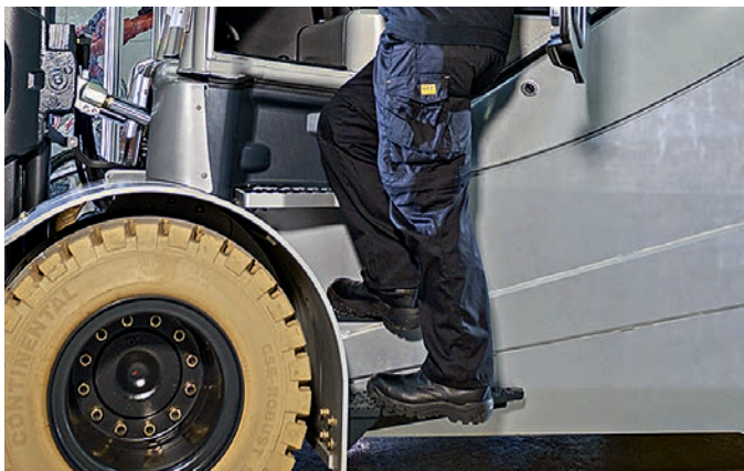
Entrada y salida segura gracias a peldaños antideslizantes visibles desde arriba
